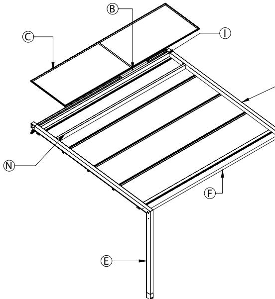
Struttura ombreggiante in alluminio con tenda richiudibile ad impacchettamento, formata da un telo (teso quando aperta) fissato ad un sistema di traversi, carrelli e guide che ne permettono lo scorrimento orizzontale. Resistenza al vento garantita fino alla classe 6 secondo la UNI PR EN 13561. Su richiesta è possibile installare il sistema antigoccia per la protezione dalla pioggia. Non si garantisce la tenuta al carico di neve.
