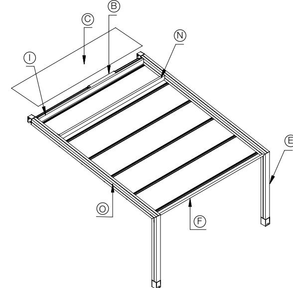
Struttura ombreggiante in alluminio con tenda richiudibile ad impacchettamento, formata da un telo (teso quando aperta) fissato ad un sistema di traversi, carrelli e guide che ne permettono lo scorrimento orizzontale. Resistenza al vento garantita fino alla classe 6 secondo la UNI PR EN 13561. Su richiesta è possibile installare il sistema antigoccia per la protezione dalla pioggia. Non si garantisce la tenuta al carico di neve.
