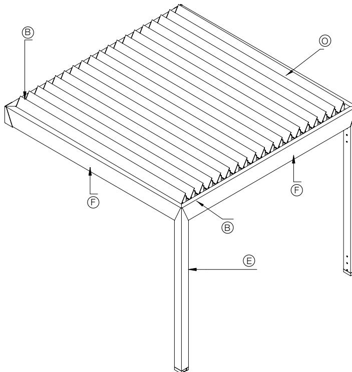
Struttura ombreggiante in alluminio con tetto a lame orientabili composta da un profilo grondaia perimetrale che permette la rotazione delle lame e lo scarico dell'acqua. La movimentazione avviene attraverso l'utilizzo di motori lineari. Resistenza al vento garantita fino alla classe 6 secondo la UNI EN 13561.
