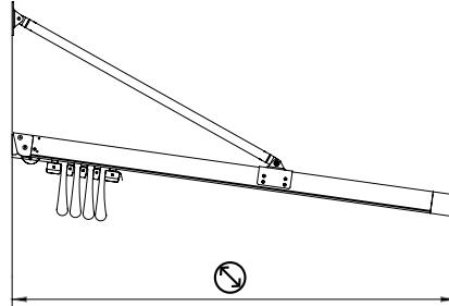
Larghezza interasse guide/Guides interaxis width/Breite des Achsabstandes der Führungsschienen/Largeur entraxe coulisses/Linea guía interaje
