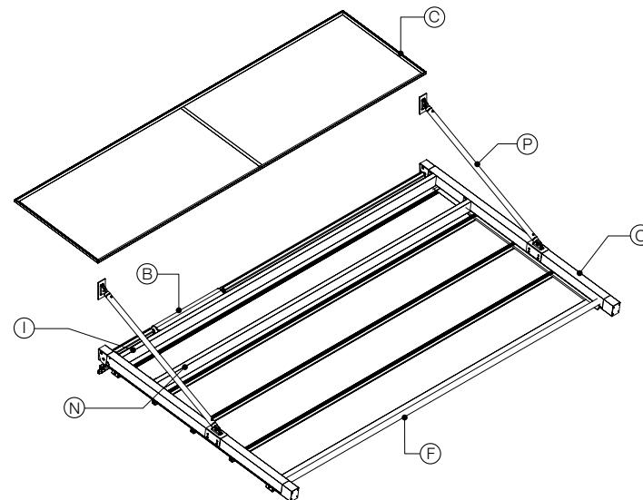
Struttura a pensilina in alluminio con tenda richiudibile ad impacchettamento formata da un telo fissato ad un sistema di traversi e guide che ne permettono lo scorrimento orizzontale. La struttura poggia su due staffe laterali che fungono da spinta e stabilizzano la struttura stessa. Resistenza al vento garantita fino alla classe 6 secondo la UNI PR EN 13561.
